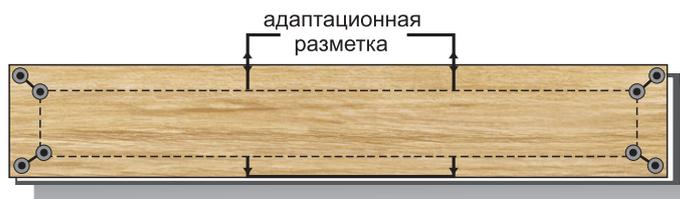
Зафиксируйте уровень диска пилы на 4,5 мм по уровню толщины плиты. Сделайте соответствующий рисунку вырез по центру доски и по контурам сбоку по линиям адапционных полос. Аккуратно демонтируйте поврежденную доску.
